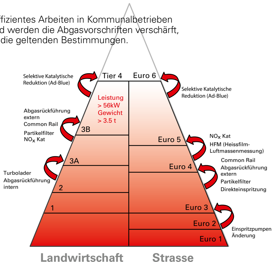
Übersicht über die Euro-Normen und die entsprechenden Motoraggregate, Grafik: HWAG/czd die zusätzlich nötig sind, um die Abgasnormen einzuhalten.
